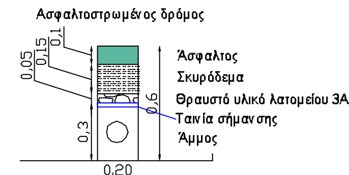
Ενδεικτικό πλάτος για εκσκαφή με τροχό (για σωλήνες Φ63 έως Φ110)
